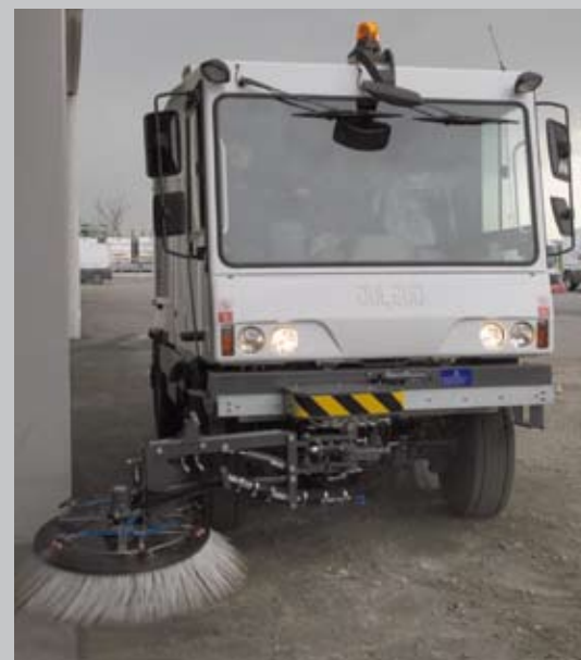
La balayeuse-laveuse combinée 5000 Combi est à la fois une balayeuse de voirie et une laveuse. Sa largeur de travail peut varier de 1 300 à 3 500 mm. Sa largeur de lavage avec rampe de lavage avant ou arrière est de 2 000 mm. Un flexible haute pression, 360° est aussi disponible. La 5000 Combi est équipée d'un filtre Gore qui stoppe toutes les poussières, mêmes les plus infimes.
