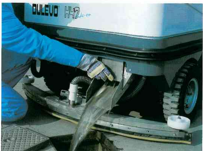
Large trappe pour le vidage du bac de récupération.
