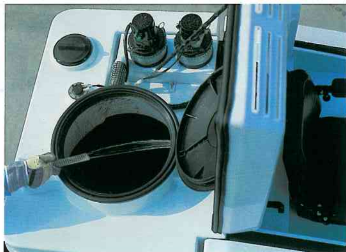
Réservoirs d'émission et récupération (Brevet DULEVO).
