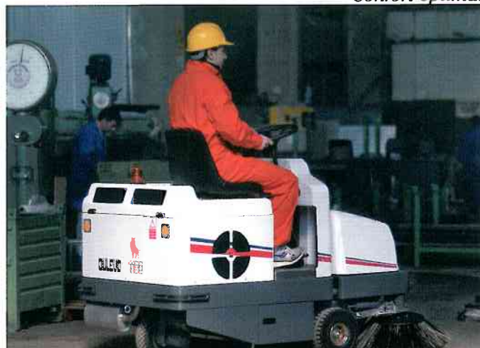
Brosse latérale à relevage automatique
