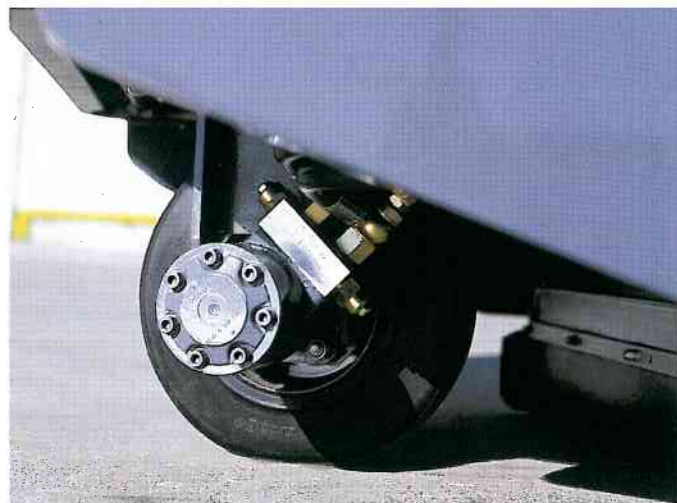
Entrainement direct de la roue arrière
