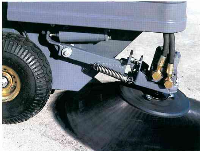
Brosse latérale à relevage automatique
